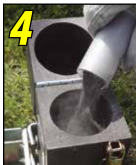
4 Pour powder into crucible.
