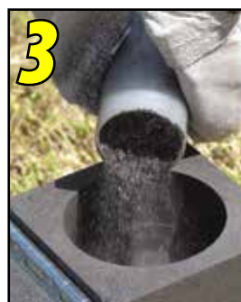
3 Pour powder into crucible.
